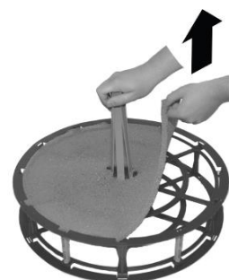
Рис. 24 Снятие внутреннего фильтра испарителя
